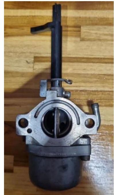
Figura 4 – Carburador Briggs e Stratton antigo 799060, Motor 19L
