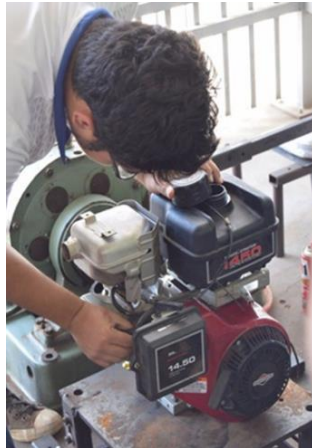
Figura 17 - Teste do motor em dinamômetro
