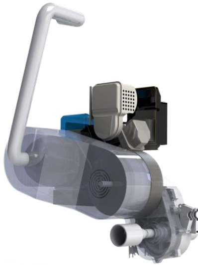
Figura 32 - Configuração final do powertrain do protótipo Moisés
