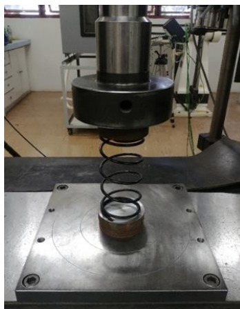
Figura 18 - Teste de tração realizado nas molas da CVT
