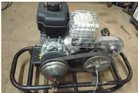
Figura 20 - Bancada construída para teste de CVT
